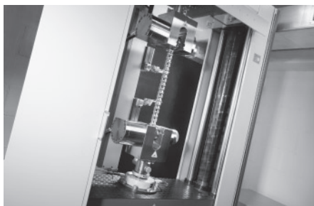
Bruchkraftermittlung und Dehnungsaufnahmen bis 1000kN
